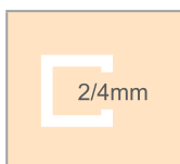
Acrílico Frontal 2mm Lateral 4 mm
